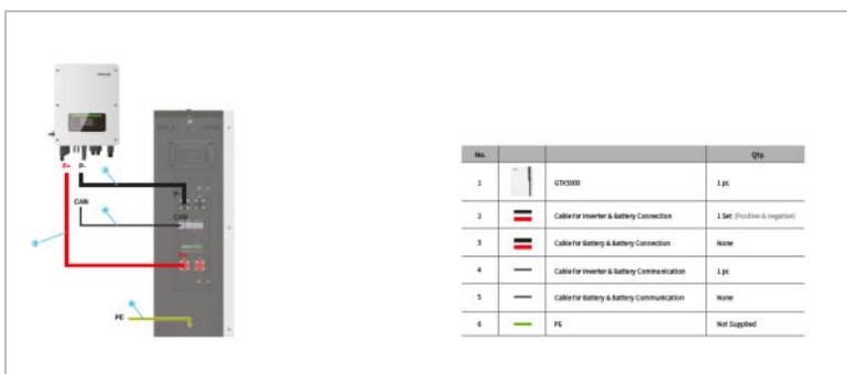
Pour les batteries avec un BMS (par exemple les batteries Li-Ion), vous devez connecter le bus CAN ou le RS485 au système de gestion de la batterie.
