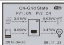
Si la production PV est égale à la consommation de la charge ( $\Delta P < 100 \text{ W}$ ), le convertisseur ne chargera ni ne déchargera la batterie.
