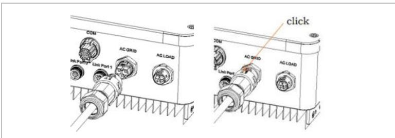
Utilisez l'outil de dépose et suivez les étapes ci-dessous pour retirer le connecteur.
