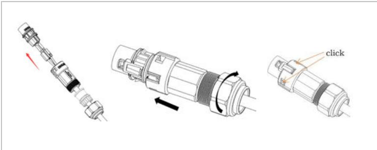
5. Connectez le connecteur AC LOAD à la prise AC LOAD.
