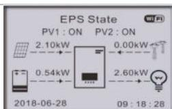
Si la génération PV est inférieure à la consommation de la charge, la batterie alimente la charge.
