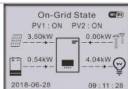
Si la génération PV est inférieure à la consommation de la charge, la batterie est déchargée pour alimenter la charge.
