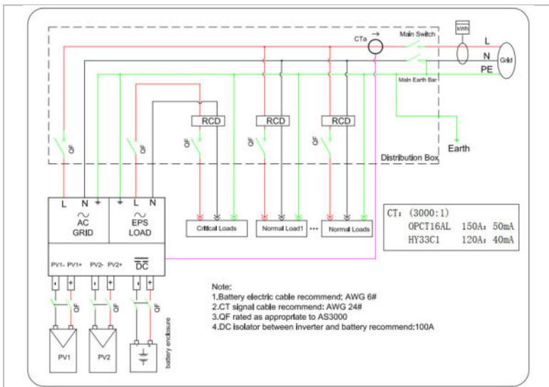
Système B : TC avec compteur d'énergie
