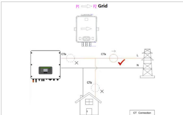
Dans une configuration sans compteur intelligent, connectez le TC aux broches 13 et 14.
