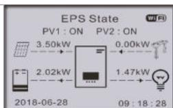
Si la production PV est supérieure à la consommation de la charge, le surplus d'énergie est stocké dans la batterie.
