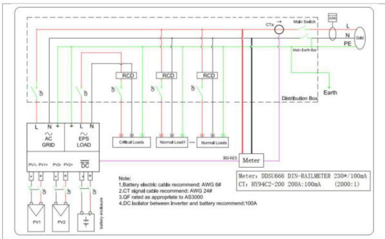
Le convertisseur HYD 3000 ... 6000-EP est compatible avec le compteur intelligent monophasé DDSU666. Les broches 15 et 16 sont utilisées pour la communication avec le compteur intelligent, elles correspondent aux broches 7 et 8 du compteur d'électricité.
