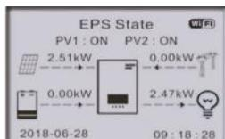
Si la production PV est égale à la consommation de la charge ( $\Delta P < 100 \text{ W}$ ), le convertisseur ne chargera ni ne déchargera la batterie.
