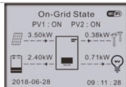
Si la batterie est pleine ou à la puissance de charge maximale, l'excédent de puissance sera exporté vers le réseau.
