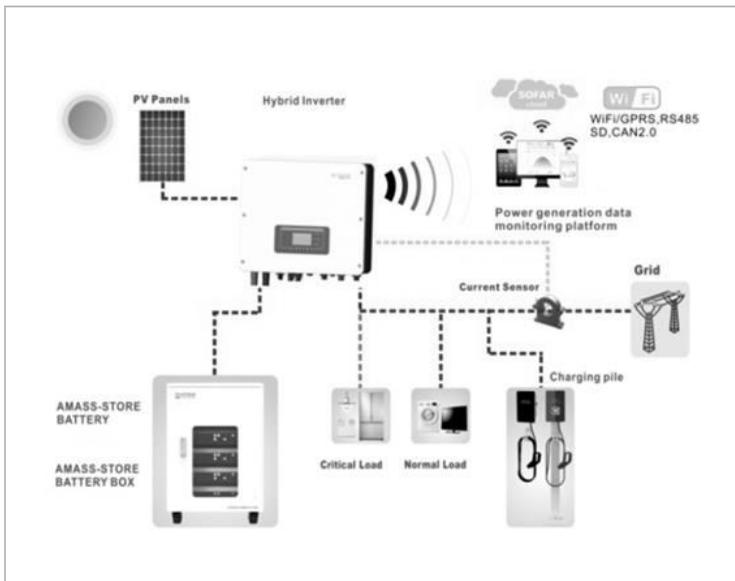
Les convertisseurs HYD 3000 ... 6000-EP ne peuvent être utilisés qu'avec des modules photovoltaïques qui ne nécessitent pas la mise à la terre d'un des pôles. En fonctionnement normal, le courant de
