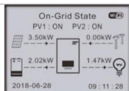
Si la production PV est supérieure à la consommation de la charge, le surplus d'énergie est stocké dans la batterie.
