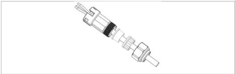
3. Bloquez les fils en serrant la vis avec une clé hexagonale.
