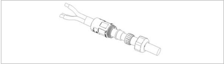
3. Connectez le câble de sortie CA conformément aux exigences suivantes et serrez le connecteur avec un tournevis Phillips.
