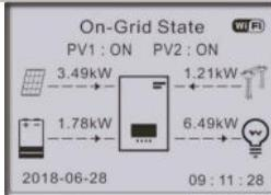
Si la charge est supérieure à la production PV plus la batterie, le convertisseur importe de l'énergie du réseau.
