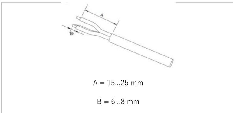
2. Démontez le connecteur conformément à l'illustration suivante : passez le câble de sortie CA dans le passe-câble.
