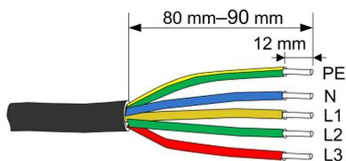
Étape 6 (**Facultatif**) Lorsque vous utilisez un câble en cuivre multi-torons et multiconducteurs, connectez le bout du fil CA à la borne située à l'extrémité du cordon (serrage à la main). En cas de fil en cuivre à toron unique, ignorez cette étape.
