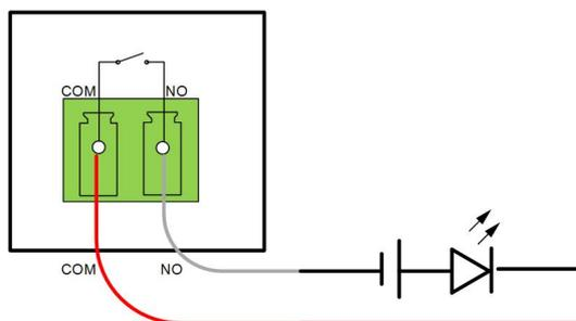
figure 5-9 Connexion DO normalement ouvert
