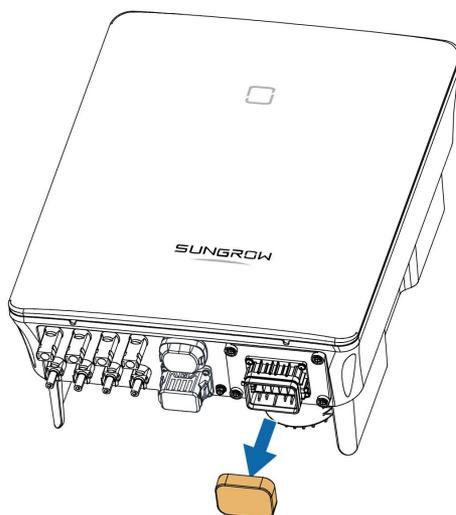
Étape 3 Soulevez le bloc de verrouillage vers le haut et insérez le connecteur AC dans la borne **AC** sur le côté inférieur de l'onduleur. Appuyez ensuite sur le bloc de verrouillage et fixez-le avec la vis.
