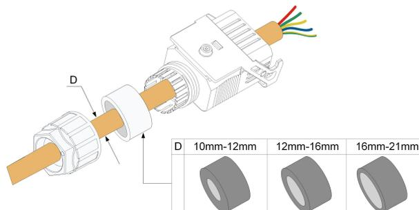
Étape 4 Retirez la gaine de câble sur une longueur de 45 mm et dénudez l'isolant du fil de 12 à 16 mm.
