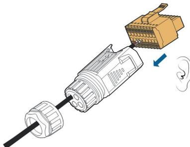
Étape 8 Serrez l'écrou orientable.
