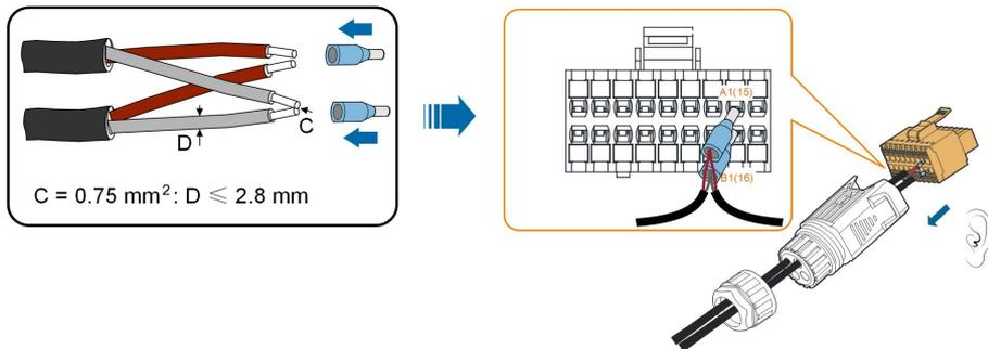
figure 5-8 Connexion en topologie en guirlande RS485
