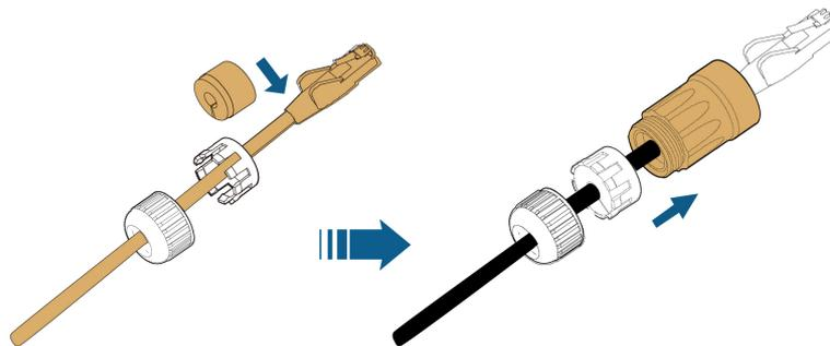
Étape 5 Insérez la fiche RJ45 dans le connecteur de fiche avant jusqu'à ce que vous entendiez un clic et serrez le boîtier. Installez le joint et serrez l'écrou orientable.
