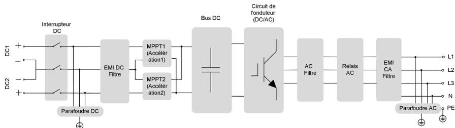
**figure 2-4** Schéma du circuit (SG5.0RT par exemple)
