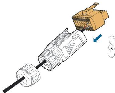
Étape 8 **Pour topologie en guirlande RS485** : Sertissez deux fils A dans une borne d'extrémité d'âme à deux fils et deux fils B à une autre borne. Branchez les bornes à A1 et B1 respectivement.
