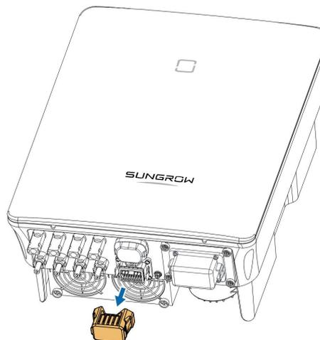
Étape 2 Insérez le connecteur COM dans la borne **COM2** sur la partie inférieure de l'onduleur jusqu'à ce que vous entendiez un bruit.
