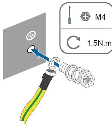
Étape 3 Appliquez de la peinture sur la borne de mise à la terre pour assurer la résistance à la corrosion.
