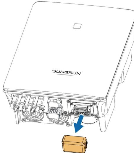
Étape 3 Insérez le connecteur AC dans la borne **AC** dans les bornes d'entrée situées sur la partie inférieure de l'onduleur jusqu'à ce que vous entendiez un bruit.
