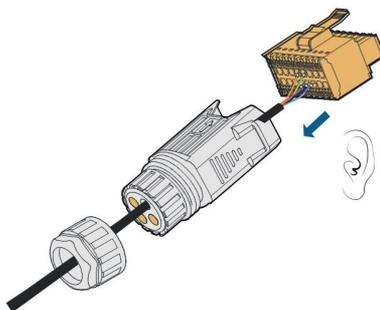
Étape 7 Serrez l'écrou orientable.
