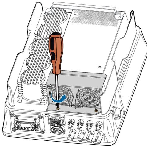
Étape 5 Soulevez le support du ventilateur vers le haut, appuyez sur la protubérance sur le connecteur de la prise d'alimentation du ventilateur et tirez vers l'extérieur et déposez le support du ventilateur.
