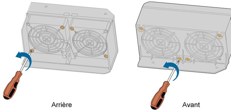
Étape 7 Utilisez une brosse douce ou un aspirateur pour nettoyer le ventilateur. Si vous devez remplacer le ventilateur, utilisez un tournevis pour dévisser la vis sur le support du ventilateur et déposez le ventilateur.
