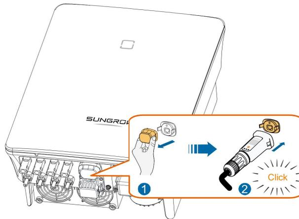
Étape 7 Secouez-le légèrement à la main pour vérifier si celui-ci est correctement installé.
