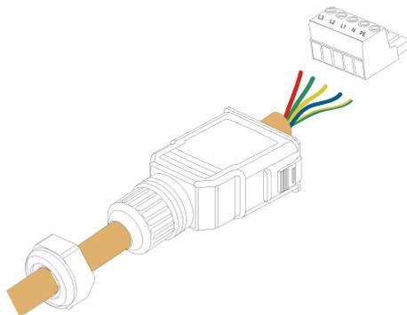
Étape 5 Retirez la gaine de câble sur une longueur de 80 à 90 mm et dénudez l'isolant du fil de 12 mm.
