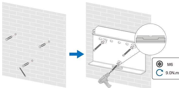
Étape 3 Soulevez l'onduleur, puis faites-le glisser le long du support de fixation murale pour vous assurer qu'il correspond parfaitement au support. Utilisez le kit d'attaches pour verrouiller l'appareil.
