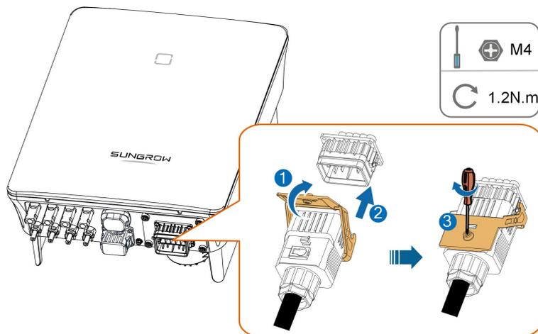
Étape 4 Connectez le fil PE à la terre et les lignes de phase à la ligne « N » au circuit du disjoncteur AC. Connectez ensuite le disjoncteur AC au tableau électrique.
