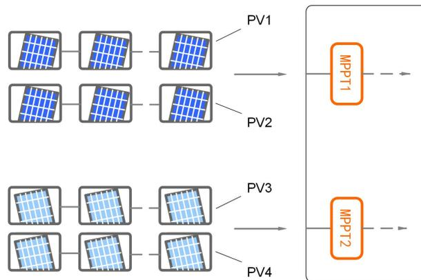
**figure 5-3** Configuration de l'entrée PV (SG20RT par exemple)
