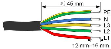
Étape 5 Ouvrez la pince sur la borne à ressort et insérez complètement les fils dans les orifices correspondants. Fermez la pince et poussez la borne dans le boîtier jusqu'à ce que vous entendiez un clic.
