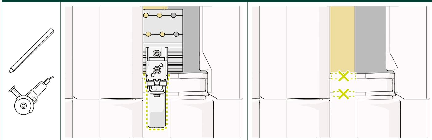
6 Alignez la plaque de base avec les trous de vis aussi près que possible du centre du chevron. Fixez la vis de la plaque de base avec un couple de 4,5 Nm.
