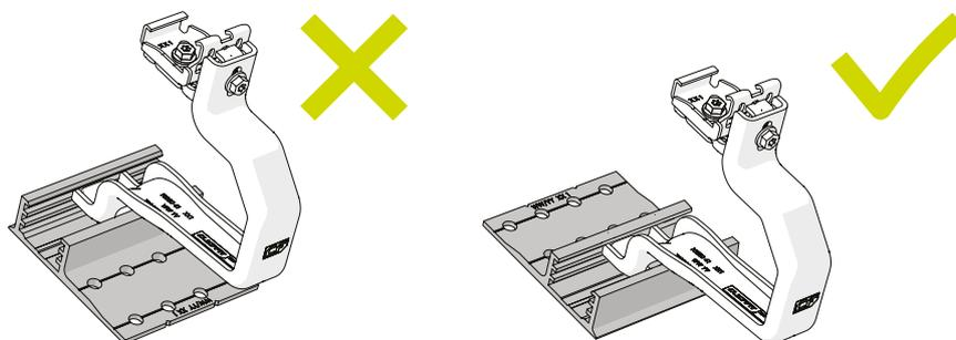
4 Ajustez la hauteur du Roof Hook PRO pour créer un dégagement minimum de 5 mm par rapport à la tuile sous-jacente.
