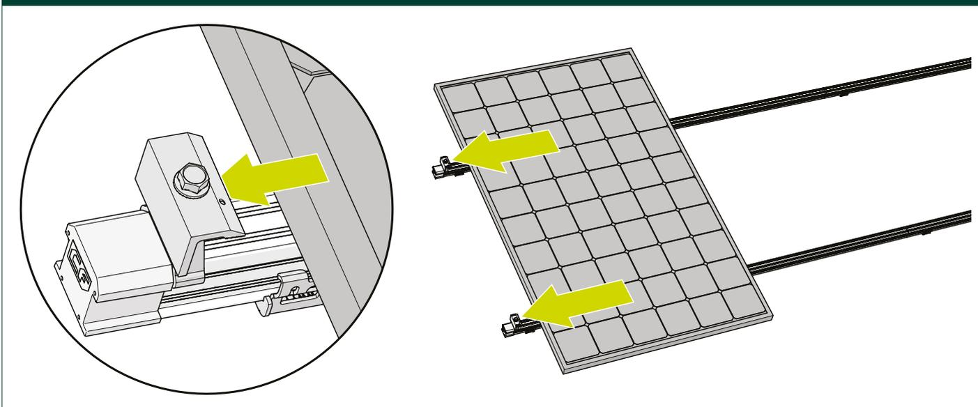
7 Serrez la vis des etriers final pour fixer le panneau. Utilisez un couple de 16,5 Nm.
