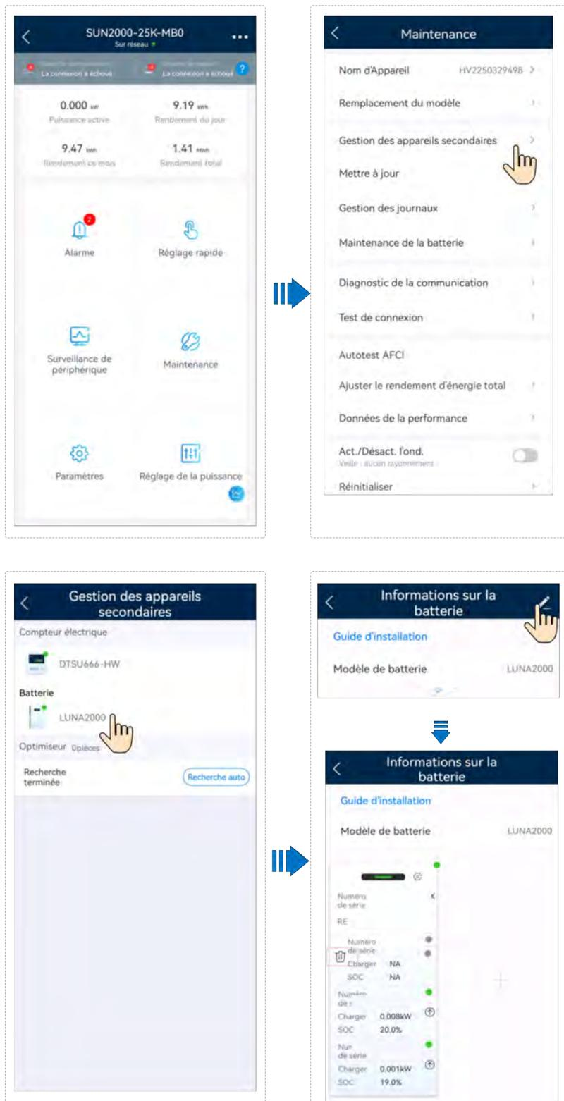
Lorsque l'EMMA est utilisé pour la mise en réseau, **branchez l'EMMA à l'application**, appuyez sur **Surveillance de périphérique** sur l'écran d'accueil, sélectionnez l'onduleur connecté, choisissez **Maintenance > Gestion des appareils secondaires**, appuyez sur l'icône ESS et supprimez le module de stockage d'énergie hors ligne.
