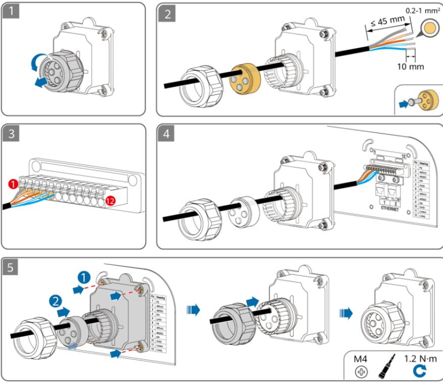
**ES** Asegúrese de que las tuercas de los bornes y las boquillas de goma a prueba de agua del ESS y los dispositivos conectados a él estén ajustadas. De lo contrario, es posible que no se consiga la calidad de resistencia al agua deseada, lo que dará a lugar a daños en los dispositivos.
