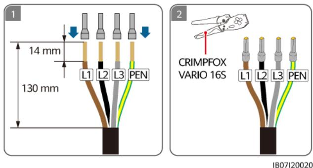
**Étape 3** Connectez le câble d'alimentation de sortie CA du réseau.
