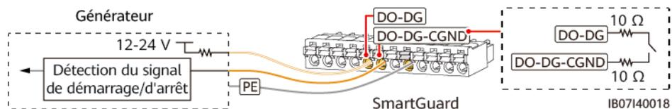
Figure E-2 Signal d'alarme du générateur
