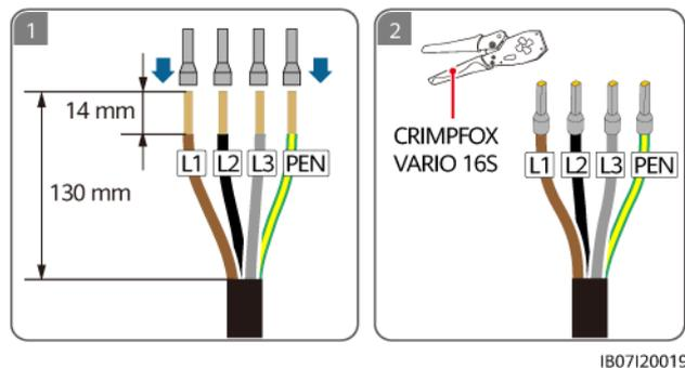
**Étape 2** Connectez le câble d'alimentation de sortie à la charge de secours. Vérifiez la charge à connecter en fonction des exigences de charge de secours.
