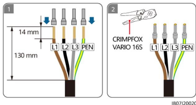
**Étape 2** Connectez le câble d'alimentation de sortie de charge non secours.
