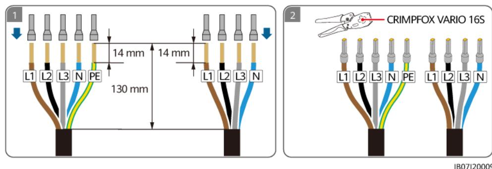
**Figure 5-9** Sertissage des bornes d'extrémité du cordon CA (système TN-C)
