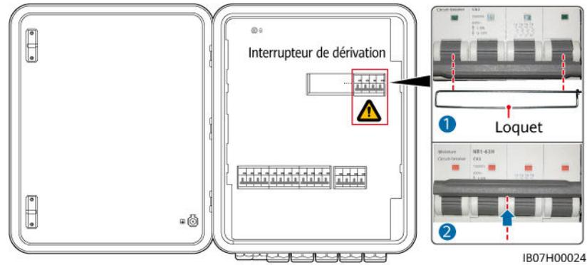
**Étape 3** Allumez les quatre commutateurs illustrés dans la figure suivante (en prenant comme exemple la connexion à trois onduleurs MAP0 en parallèle).
