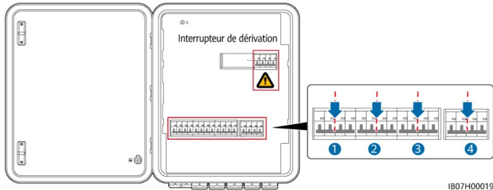
2. Retirez le loquet du commutateur de dérivation, mettez sous tension le commutateur de dérivation, puis mettez sous tension les commutateurs 3 et 4 figurant dans la figure.
