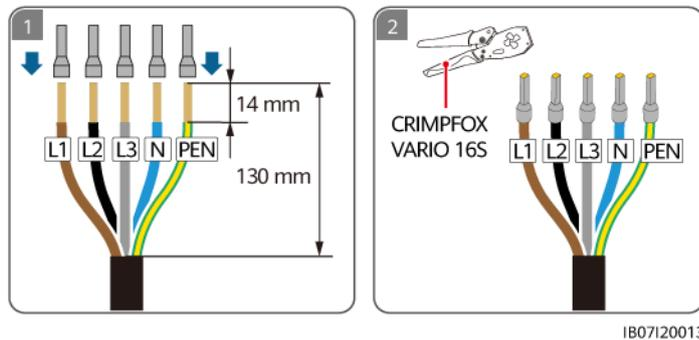
**Figure 5-16** Sertissage des bornes d'extrémité du cordon CA pour le SmartGuard-63A-AUTO0 (système TN-S/TN-C-S/TT)
