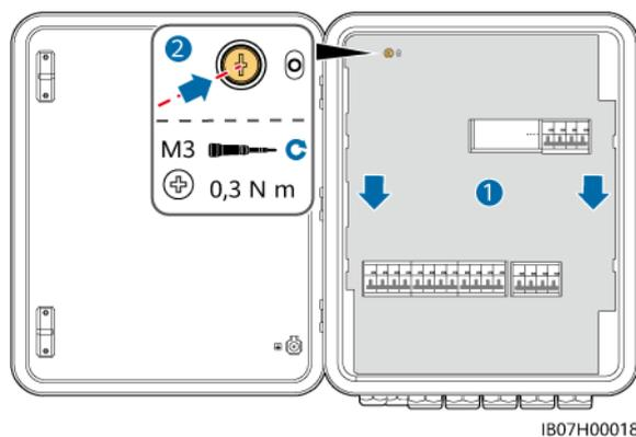
**Étape 2** Avant de fermer la porte du compartiment de maintenance, activez les quatre commutateurs indiqués dans la figure suivante (en prenant comme exemple la connexion à trois onduleurs MAP0 en parallèle).
