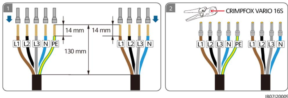
**Figure 5-22** Sertissage des bornes d'extrémité du cordon CA (système TN-C)
