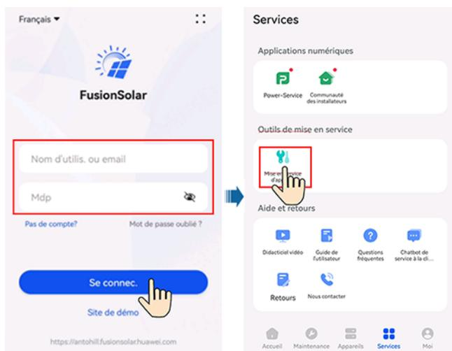
**Étape 2** Connectez-vous au WLAN du SmartAssistant en tant qu'**Installateur** pour accéder à l'écran de mise en service de l'appareil.
