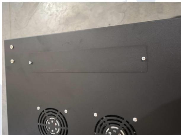
Fixez les caches de ventilation/câblage à l'aide de vis autotaraudeuses.
