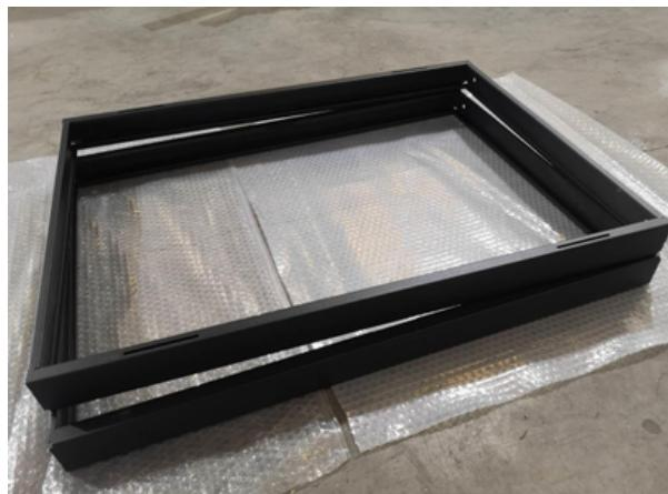
Vérifiez l'orientation des fentes pour garantir la fermeture correcte des portes latérales.
