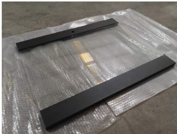
La porte comporte un trou pour l'installation de la serrure et la connexion à la terre.
