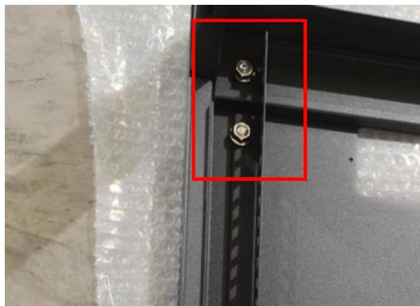
Fixer les supports de montage aux 4 angles de la base à l'aide de vis hexagonales.
